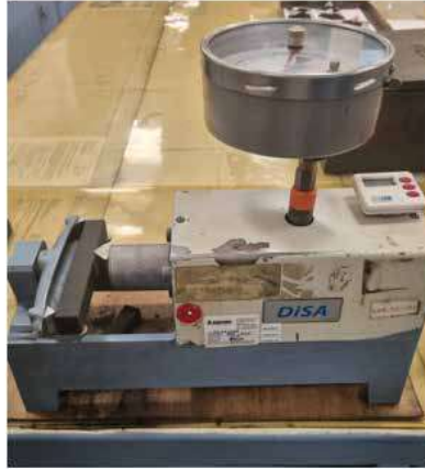
Şekil 6: Kırılma mukavemeti ölçüm cihazı
