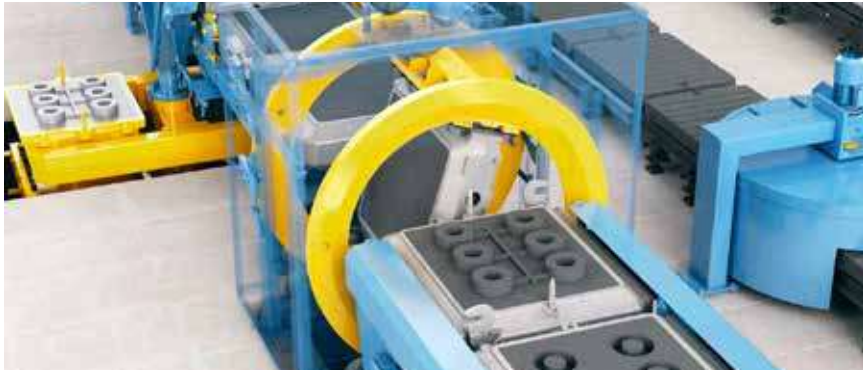
Resim 6 : Kalıpların Oluşturulması İçin Derecelerın Çevrilmesini Sağlayan Kalıp Çeviriciler
