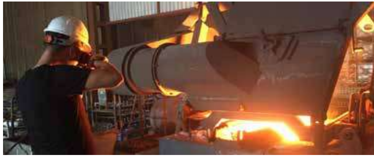
Şekil 12 : Taşınabilir Optik Pirometre ile ölçüm
