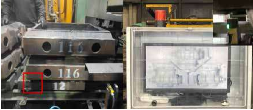
Resim 14 : Kayan Dereceler, Tespit Eden Sensör ve Sesli Işıklı İkaz Lambası
