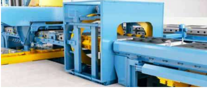
Resim 5 : Kalıpların Üzerinde İlerlemesini Sağlayan Rulman ve Raylardan Oluşan Kalıp Konveyörü
