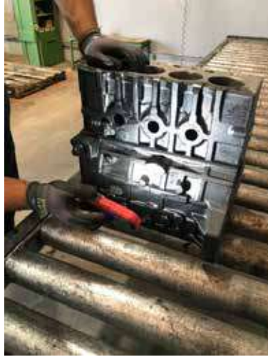
Şekil 4: Yüksek Lümenli Işık ile Parça Kontrolü
