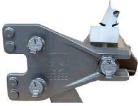
Şekil 8: (3) Eğimli noktasal besleyiciyle beslenen kamyon braketi dökümü
