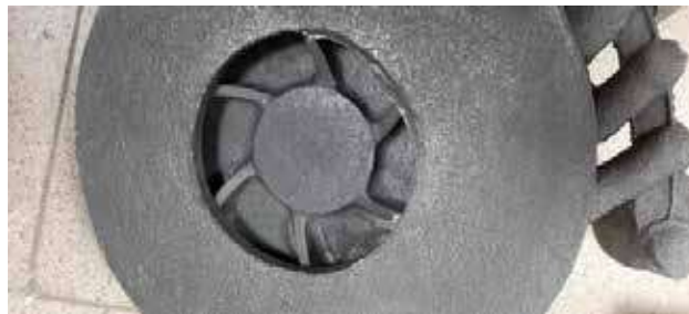
Şekil 3: Zirkon refrakterli boyayla kaplanan maça kullanılarak dökülen düşük ve orta alaşımlı çelik döküm yüzeyi.
