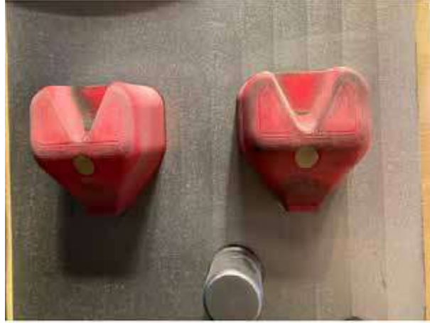
Resim 5 : ABS malzemesi kullanılarak üretilen besleyici kalıplama denemesi
