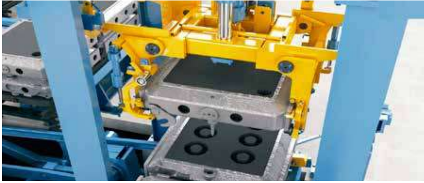
Resim 7 : Kalıp Kapatma İstasyonu
