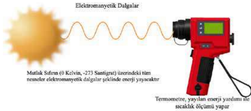
Şekil 1: Radyasyon Termometreleri Kullanılarak Temel Sıcaklık Ölçümü
