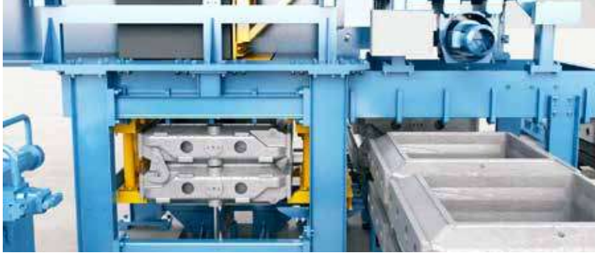
Resim 8 : Kalıp Bozma İstasyonu
