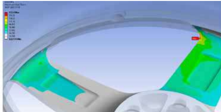
Şekil 22 : 8,5X19" DRD geçen jantı simülasyonu sonucu çıkan maks. stres değerleri
