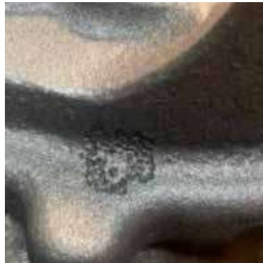
Şekil 4: Görülen balıkgözü hatasının görünümü.
