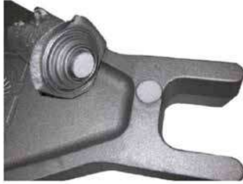
Şekil 9: Kesildikten sonra noktasal besleyici, minimum boyun ile kalır.
