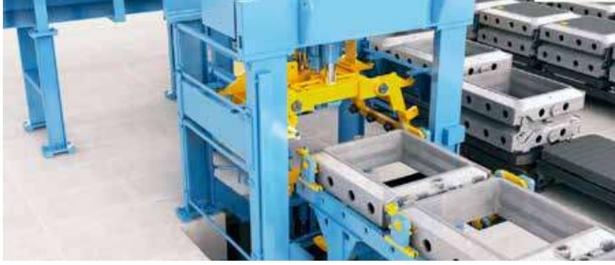
Resim 9 : Derece Ayırma İstasyonu
