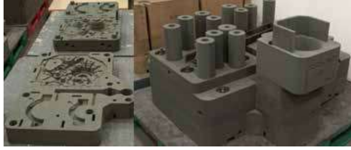
Şekil 3: 3D yazıcı ile üretilmiş maçalar ve kalıp
