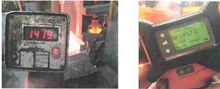
Şekil 16 : Döküm Potasından Ölçülen Sıcaklık
