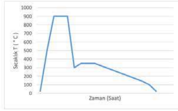
Resim 1: Uygulanan Östempereleme ısıl işleminin şematik gösterimi.
