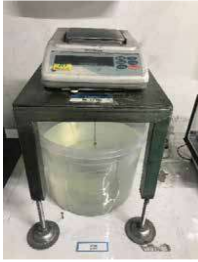
Şekil 1 : Arşimet Prensibine Dayalı Yoğunluk Ölçüm Cihazı
