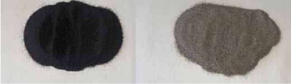
Şekil 9: Kalıplama Atık Kumu (Solda) ve Reklamasyon Çıktı Kumu (Sağda) Görünüşü
