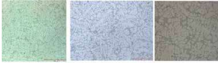
Şekil 19 1 Toz, 1 Yaş Boya Kol-Dış Rim 25x 50x 100x mikro yapı
