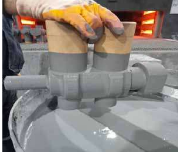
Resim 3 : Daldırma yöntemi ile boyanan maça
