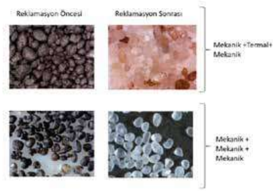
Şekil 5: Atık Kalıp Kumunun Reklamasyonu Kum Mikroskop Görüntüleri
