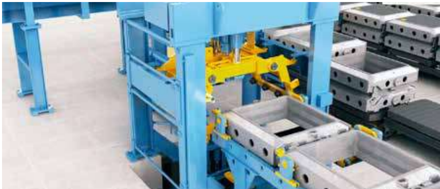
Resim 10 : Transfer Arabalarının (Palet Arabaları) Temizleme İstasyonu
