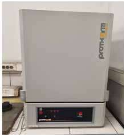
Şekil 7: Yanma kaybı ölçüm fırını
