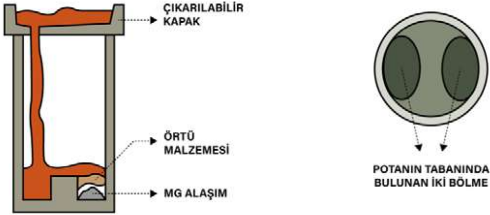
Resim 8: Tandış pota Yöntemi (Lerner and Pantelev ,2003)
