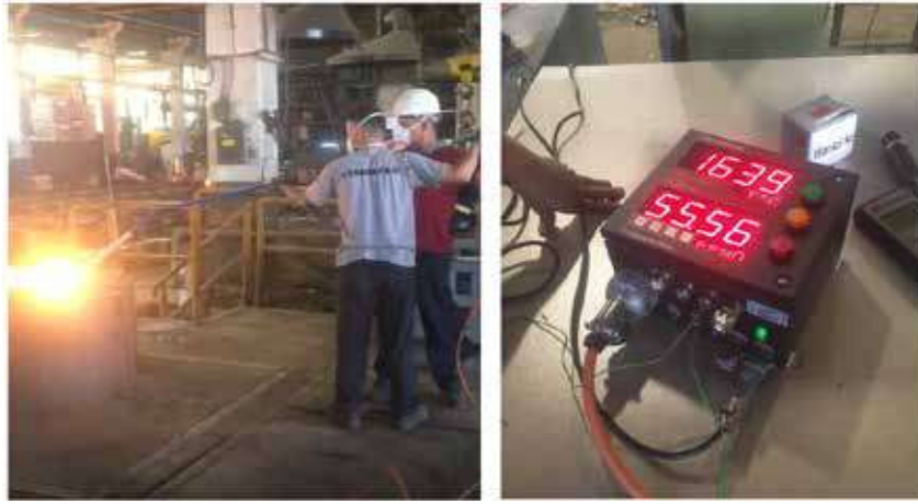
Şekil 4: İndüksiyon fırınlarında sıcaklık ve oksijen seviyesi ölçümleri
