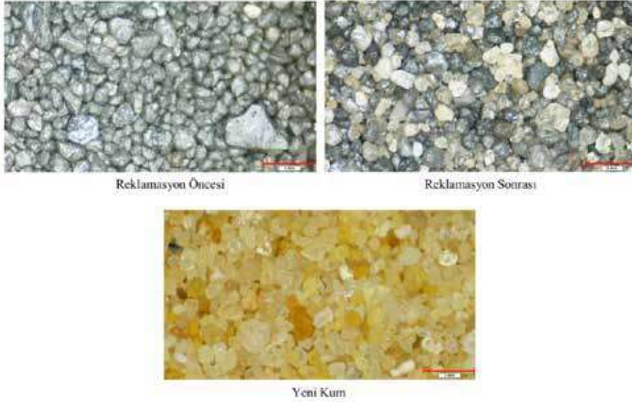
Şekil 2 : Reklamasyon öncesi, reklamasyon sonrası ve yeni kumun mikroskop altındaki görüntüleri
