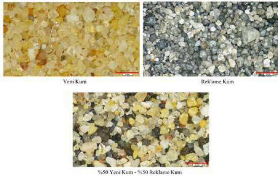
Şekil 3 : Yeni Kum, reklame kum ve %50-%50 karışım kumunun mikroskop altındaki görüntüleri
