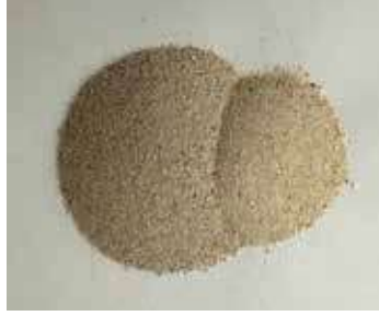
Şekil 11: Reklamasyon Çıktı Kumu (Solda) ve Silis Kumu (Sağda) Fiziksel Görünüşü
