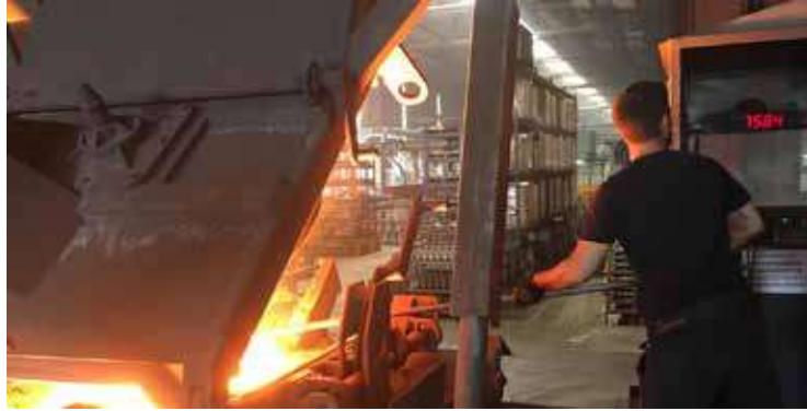
Şekil 11 : Daldırma Tip Kartuşlu Termokupl ile ölçüm
